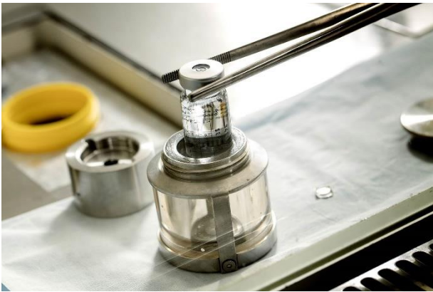
Figur 14 Fremstilling af radioaktive lægemiddel til undersøgelse af nyrefunktionen. Bemærk at bioanalytikeren beskytter sig mod ioniserende stråling ved at opbevare kittet i beholder af blyglas. Foto: KP-billedsamling
